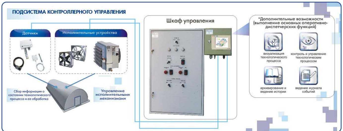
Рис. 3 - Подсистема контроллерного управления с дополнительными возможностями
