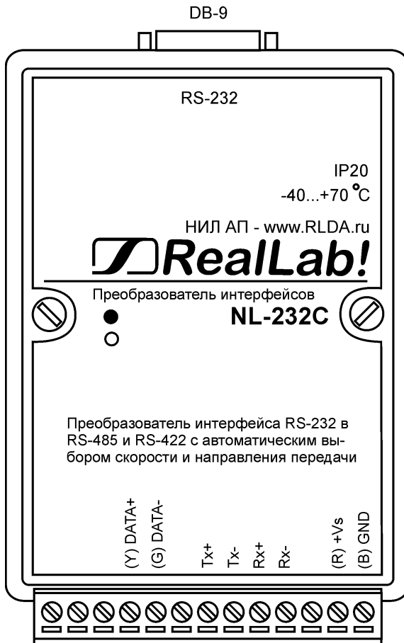
Рис. 1.1. Вид сверху на модуль NL-232C. Модули NL-232-485C и NL-232-422C отличаются только надписями и цоколевкой разъемов
