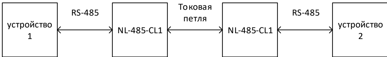
Рис. 2.1. Структурная схема подключения модулей NL-485-CL1
